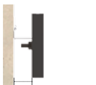
solo 38 mm de distancia entre la pared y la lama.
